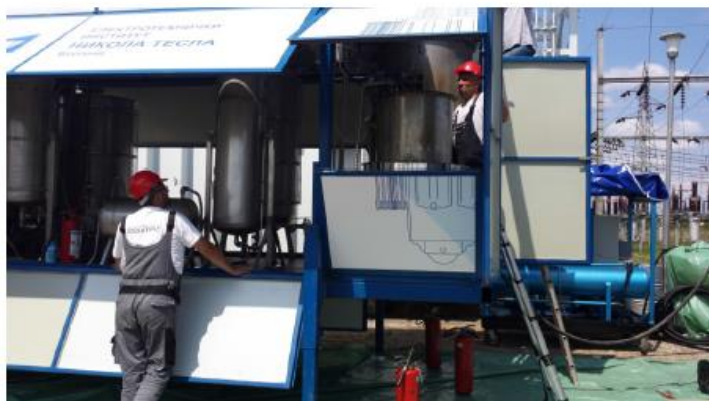
Слика 4.6. Мобилно постројење за деконтаминацију РСВ
