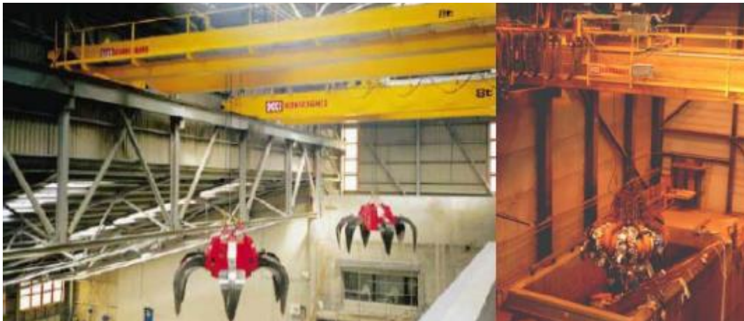
Слика 6.26. Изглед крана са грабилицом за отпад
