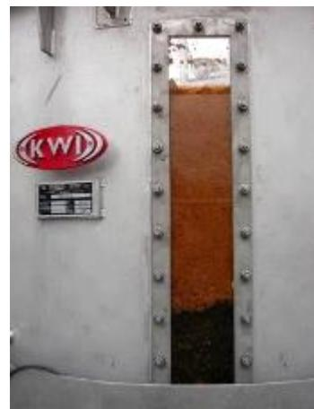
**e:** Sistem za saturaciju sa saturatorom najnovije generacije tipa ADR (Air Dissolve Reactor) i pumpom za saturaciju
