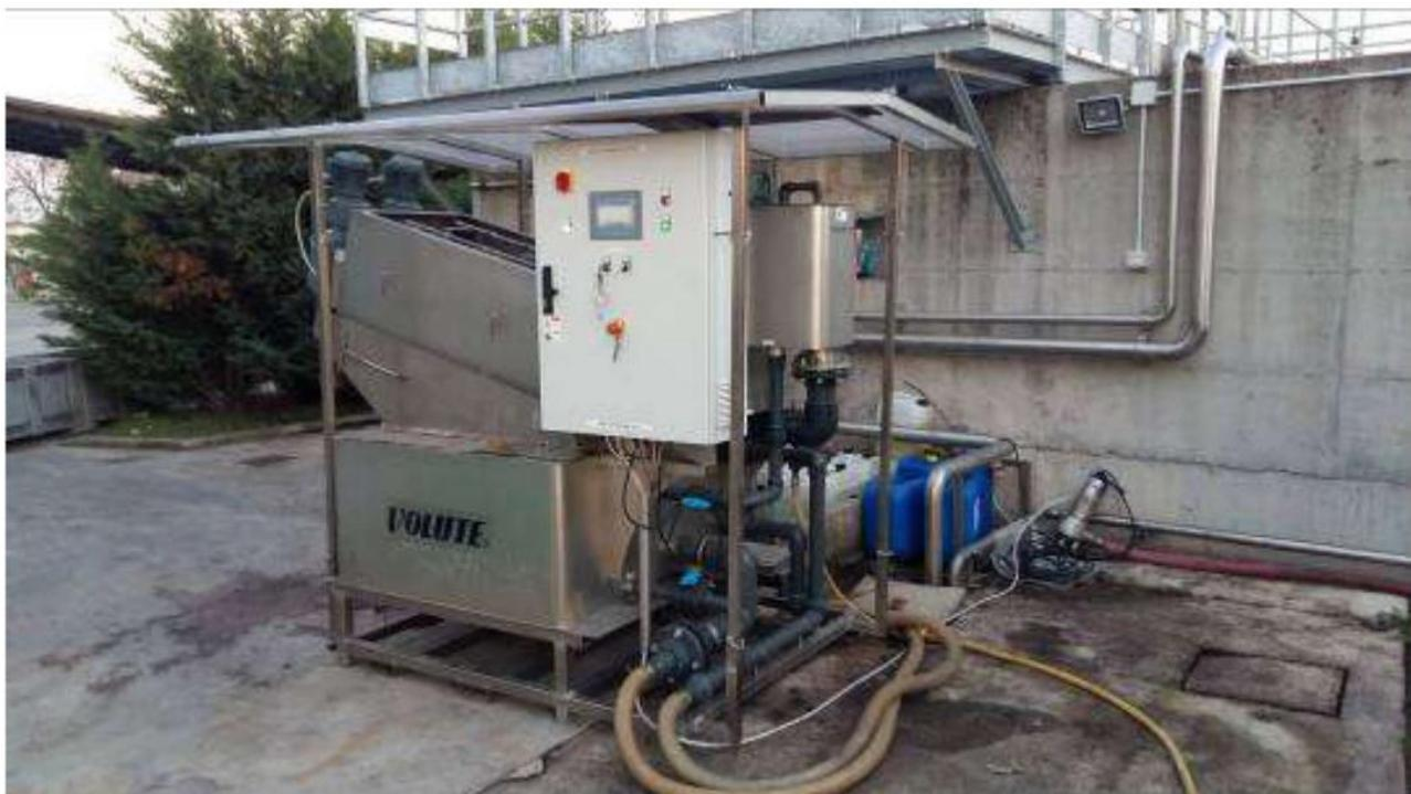
Specijalna vijačna presa sa diskovima za mašinsku dehidraciju mulja
